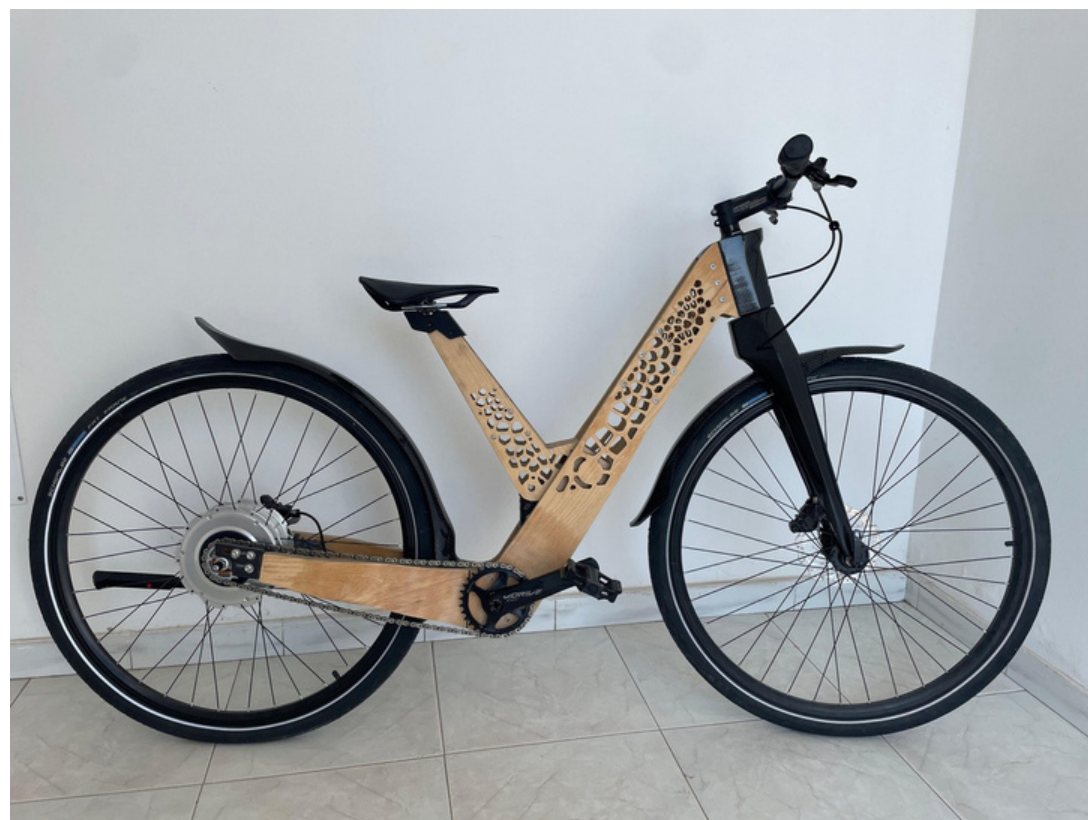
Prototipo di bicicletta in compensato e carbonio riciclato .
