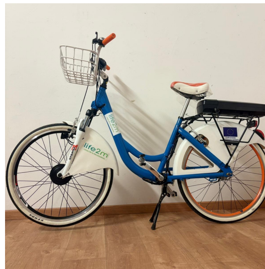
Prototipo di bicicletta muscolare con il kit di retrofit .
